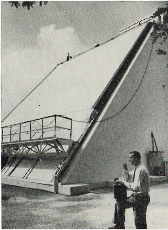
Fig. 6. Bendix Electronic Steerable Array Radar (ESAR) är uppbyggd av flera tusen antennelement, som matas individuellt i faslägen, som styrs elektroniskt. Härigenom kan strålen skiftas mellan två godtyckliga lägen på mindre än 20 \mu s.
