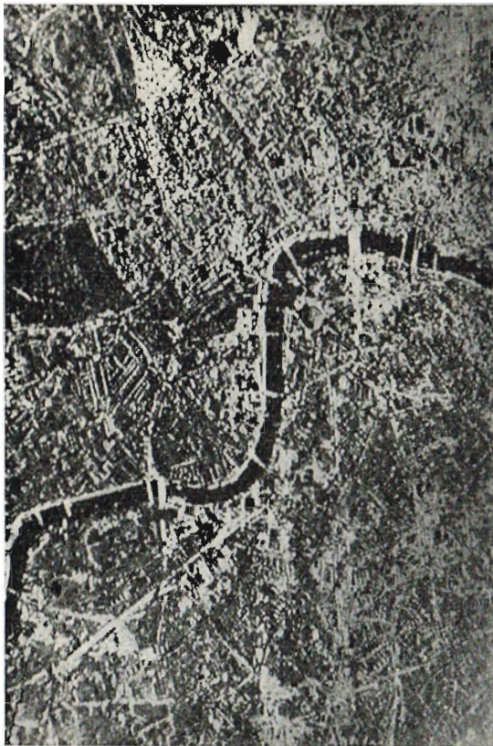
Fig. 13. Londons centrum sett med "sidtittande" radar. De mörka fyrkanterna upptill till vänster är Hyde Park och Regent's Park; i centrum ser man bl.a. departementsbyggnaderna vid Whitehall som en markerad, ljus fyrkant.
