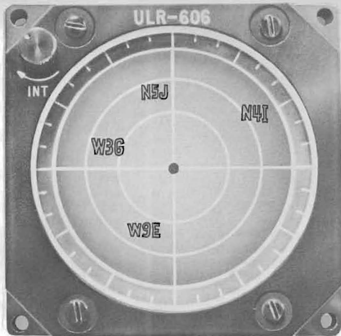
Fig 6: Modern radarvarnare visar information på ett litet instrument (scope) — förutom riktning även pulsängd (N eller W), pulsrepetitionsfrekvens (0–9) och våglängd (E, G, I eller J).
