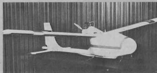
Fig 4: RPV av denna typ (E-systems E-75) kan vara en aktuell plattform för motmedelsinsats. E-75 – som kallas LCEHV/Low Cost Expendable Harassment Vehicle – skall kunna ligga/sväva omkring över ett målområde upp till ca 6 tim med en last av ca 14 kg.
