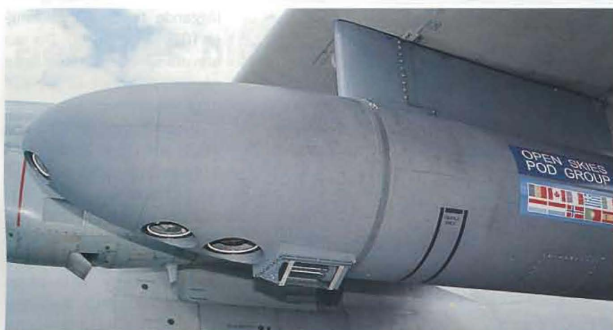
Denna kamerakapsel har specialkonstruerats för Hercules och används av tio Open Skies-länder.
