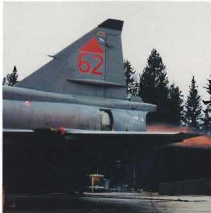
Provkörning av RM 8B efter motorbyte på Optands flygfält.
