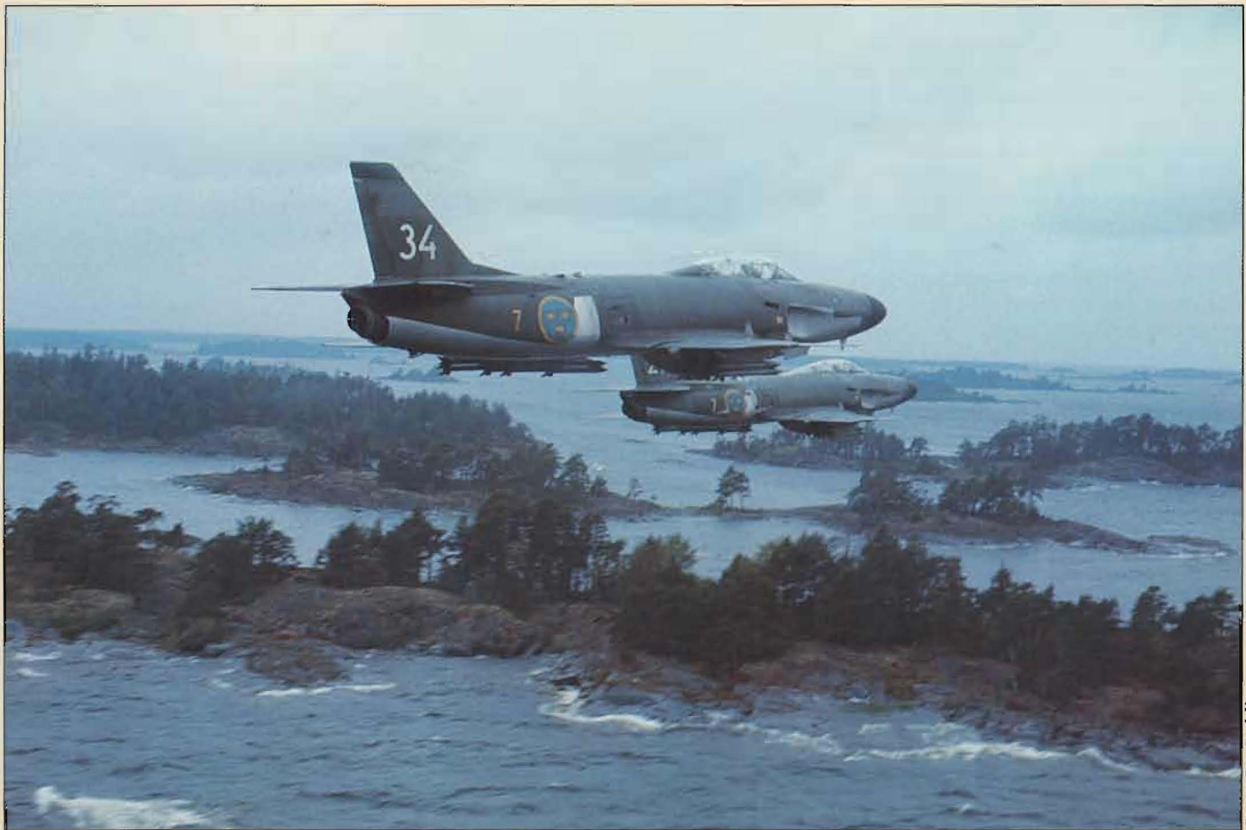
Saab 32 Lansen provflögs i attackutförande 1952. Som övningsstörare och måldragare, J 32 D/E, i mållflygorganisationen flyger fortfarande cirka 20 Lansen, som är modifierade J 32B. Typen har alltså närmare 45 år i tjänst, något som måste vara snudd på rekord.
