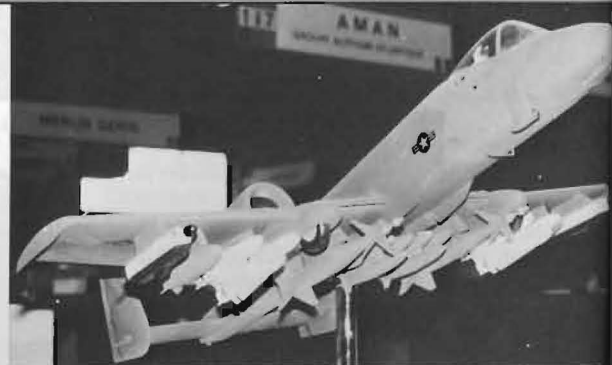
Ovan: Fairchild A-10 'Thunderbolt 2' med omfattande attacklast och två motmedelskapslar typ AN/ALQ-131 avsedda för elektronisk egen- och medstörning. (Bilden tagen under 'Paris-Salongen' 1979.) – T v: En 4-grupp A-10 med äldre typ av ECM-kapslar för med- och eskortstörning.
