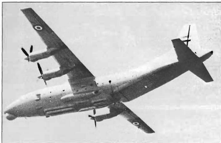
Ovan: Motmedelsversion av sovjetbyggda Antonov An-12 "CLUB C" avsedd för bakgrundsstörning (här med egyptiska nationalitetsbeteckningar). Antennerna till störsändarna är placerade under kroppen.
