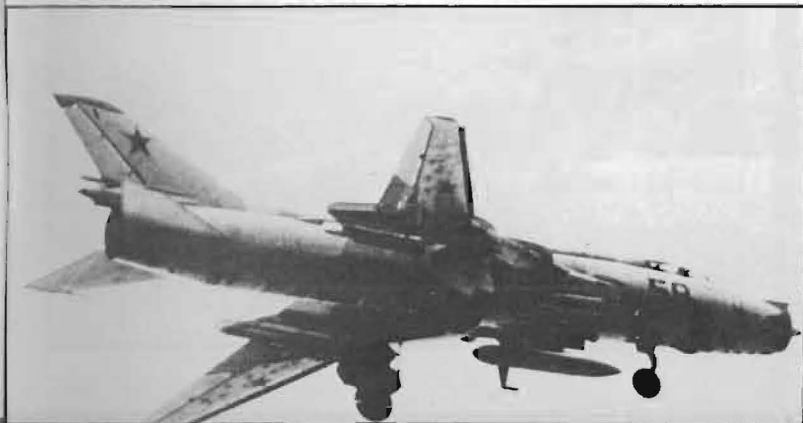
Sovjetiska Su-17 "FITTER C" utrustad med en motmedelskapsel, troligen avsedd för medstörning. Kapslar av den här typen kan sannolikt också flyttas över till andra flygplan. ▼
