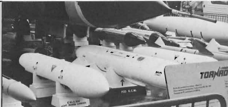
Stor elektronisk störkapsel för 'Tornado'. Sannolikt avsedd för medstörning. ▼
