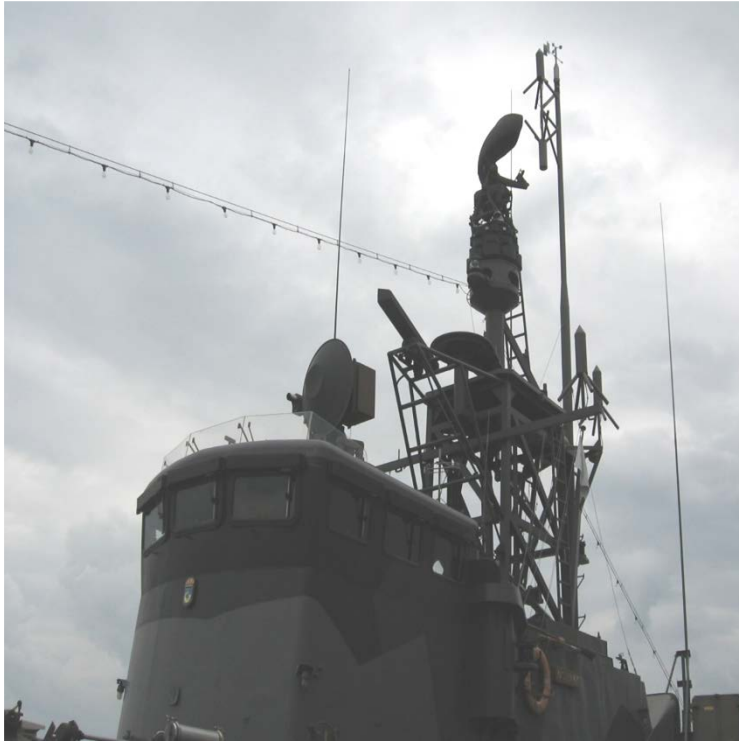
Bild 29. Modifierad antennplacering PQ-826, under spaningsradarantenn
