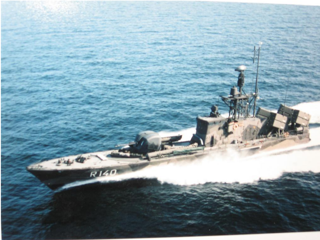
Bld 32. PQ-868 antenninstallation på robotbåt typ Norrköping (framför och under PQ 826)
