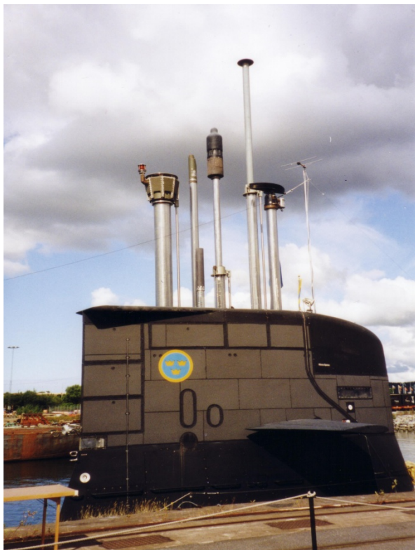
Bild 14. Torn med master och antenner. (SIS-antennen på masten i mitten). Ub Hgd.
