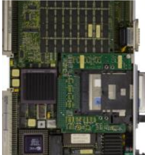
VME datorkort med en Motorola 68040 och en 68020 processor
