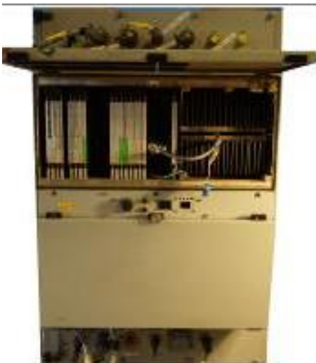
Datorskåp med en Philips P857 CPU monterad baktill i skåpet
