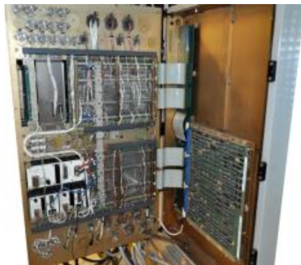
Datorskåp med en Philips P857 CPU monterad baktill i skåpet
