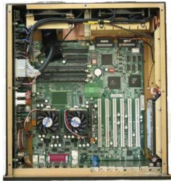
Ruggad PC med dubbla processorer på ATX moderkort
