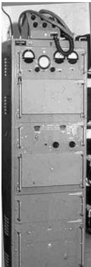
200 W KV-sändare m/52. Användes även av Kustartille- riet. Tillv. Philips
