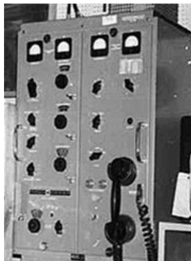
50 W KV-sändare m/54 Användes även av Kustar- tilleriet. Tillverkare: SRA
