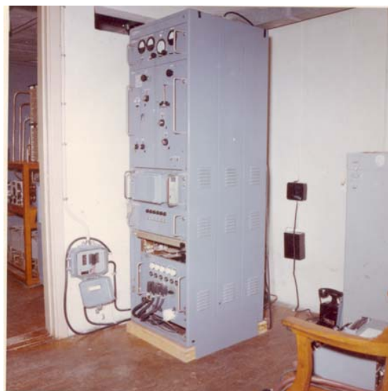
Apparatrum, sändare 1,5 kW m/54.
