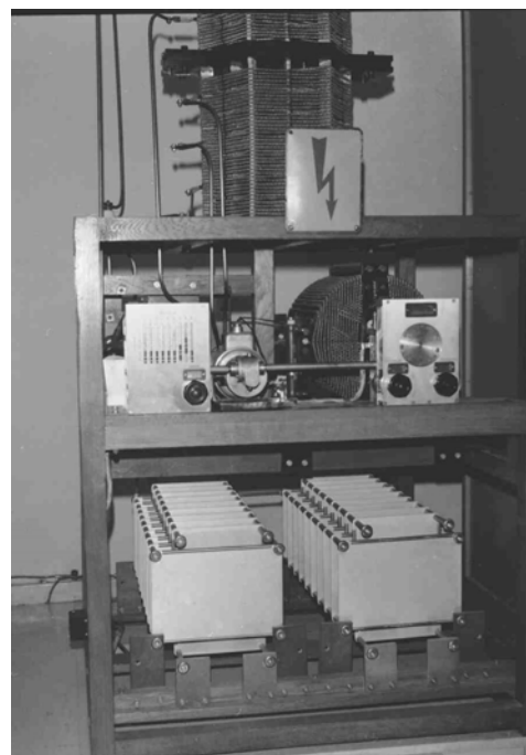
Antennavstämningseenhet till 3 kW LV-sändare.
