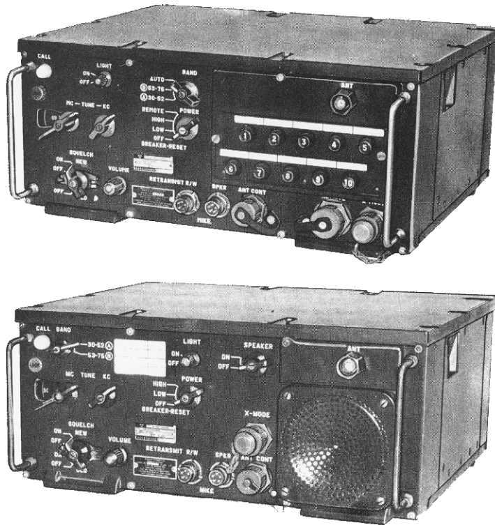
Bild 47. Sändtagare Ra 421 (överst) och Ra 422 (underst). Endast Ra 422 användes inom marinen.
