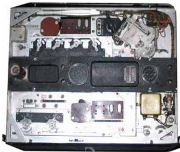
Bild 14. SM-enhet med luckorna öppnade. Den komplexa mekaniken syns här. "Staven" längst till vänster i mittdelen är en konstantenn, en glödlampa som användes vid trimning.
