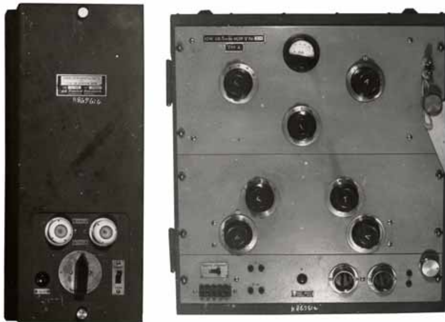
Bild 6. 10 W UK-station m/39. Sändar- och mottagarenhet till höger och växelströmstillsats till vänster.
