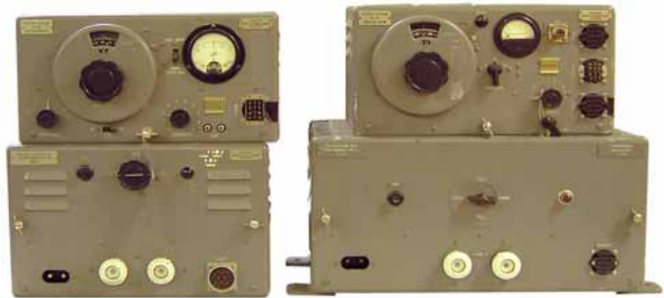
Bild 11. 50 W FMUK-stn m/44. Överst till vänster mottagare, under den kraftaggregat typ B. Överst till höger sändare, under den kraftaggregat typ A.
