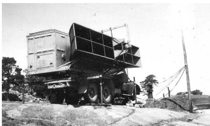
Ursprungsvarianten AMES-14. Lägg märke till den dubbla ostformade antennen.
