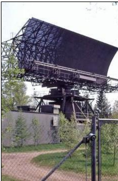
Storradarstationerna PS-08 och PS-65 var oftast samgrupperade med radarhöjdmätare PH-12 och/eller PH-40.
