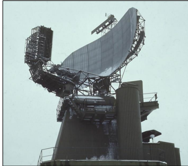
Storradarstation PS-66 också av 3D-typ normal rotationshastighet.
