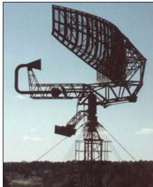
Storradarstationerna PS-08 och PS-65 var oftast samgrupperade med radarhöjdmätare PH-12 och/eller PH-40.
