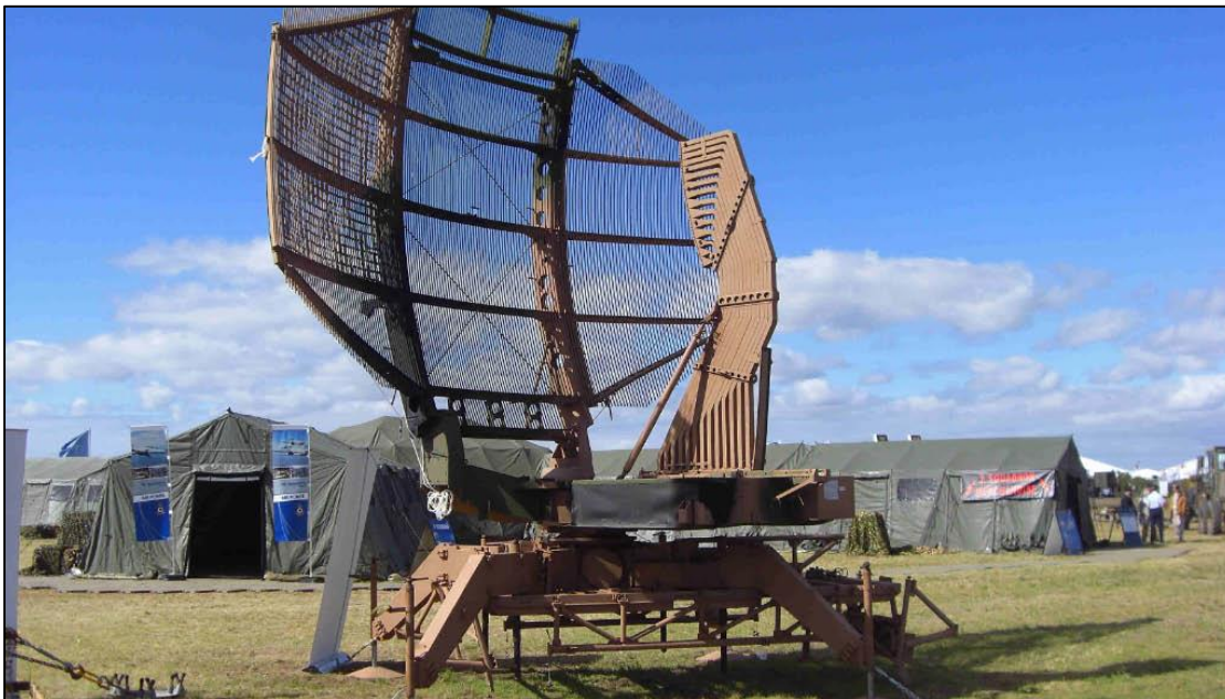
Westinghouse A/N TPS 43, exempel på radarstation på internationella marknaden och aktuell för PJ-60. Bilden visar en senare version.
