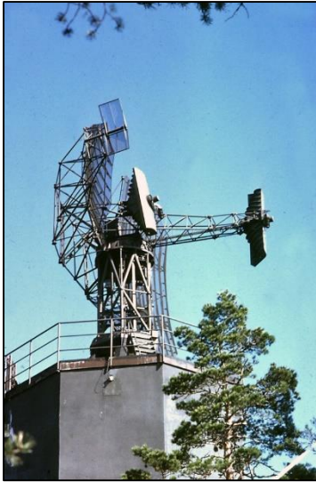
PH-39 radarhøjdmätare av 3D-typ, låg rotationshastighet.
