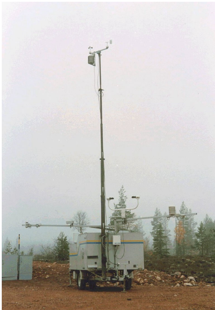
FMV utvecklade tillsammans med Ericsson en mobil observationsplattform avsedd att användas inom Bas 90-systemet. Utrustningen kom aldrig att serietillverkas. Provxemplaret överfördes till VädS där den kom att utgöra en viktig resurs i försök- och provverksamheten. Utrustningen på vagnen modifierades fortlöpande. Vagnen försågs bl a med minisodar.
