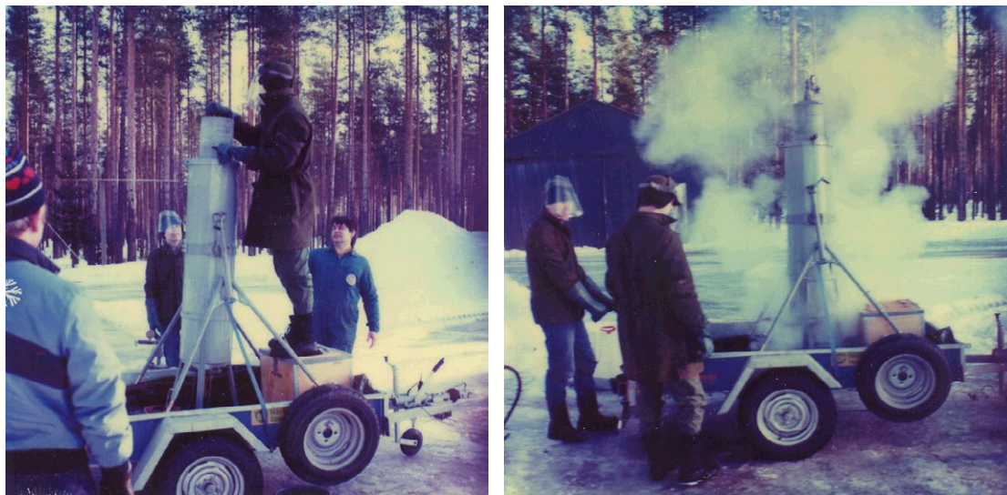
För att säkerställa tillgång till vätgas i fält konstruerades en vätgasgenerator. Den användes från mitten av 60-talet fram till början av 90-talet.
