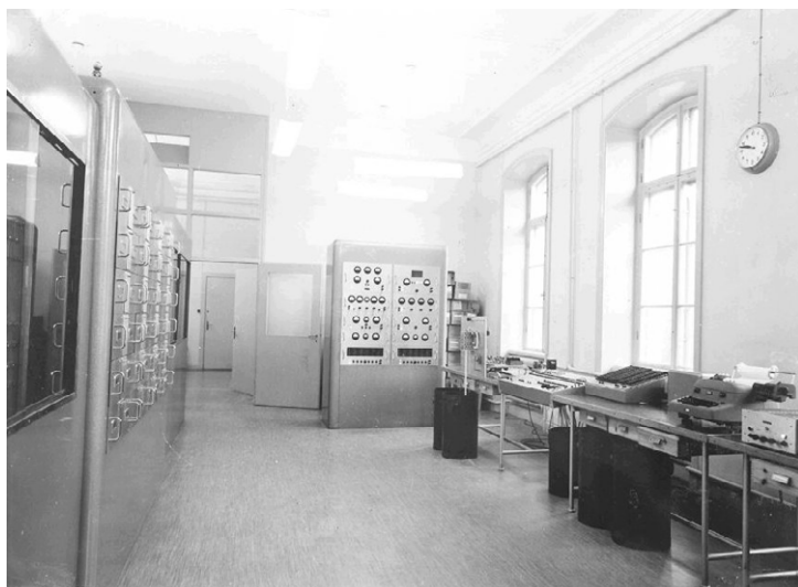
Manöverrummet för "elektronhjärnan" BESK, vid sin tillkomst 1953 världens snabbaste dator med ett internminne på 1000 40-bitars ord samt 8 K trumminne (den tidens yttre minne).
