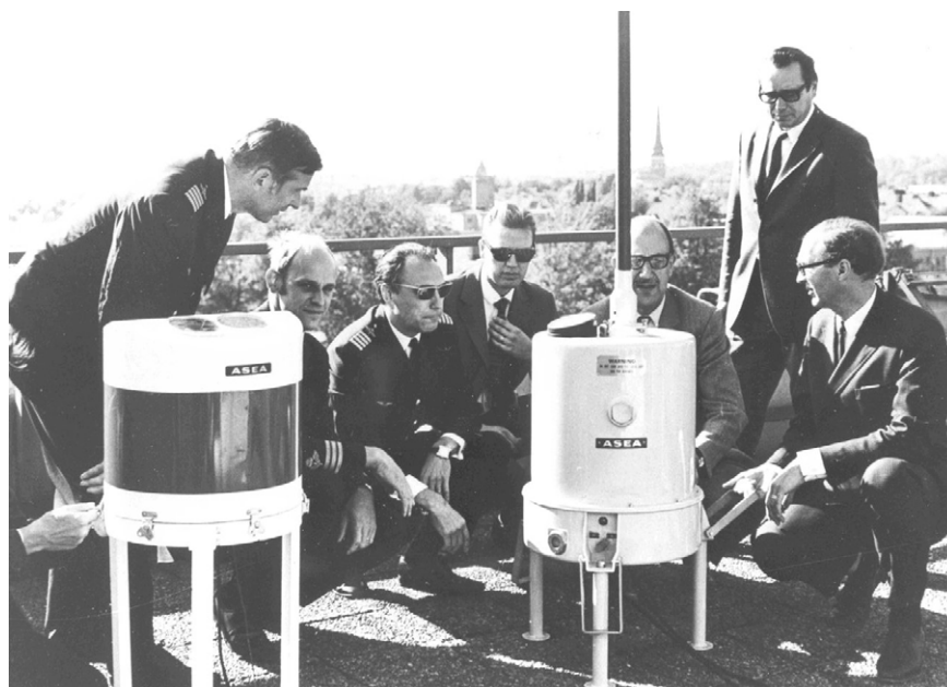
I början på 70-talet utvecklade ASEA en ny generation molnhöjdmätare som byggde på laserteknik. Högeffektlasern, den högra utrustningen på bilden, tillfördes flottiljerna. Lågeffektlasern, till vänster på bilden, användes även på krigsbas. (Bilden tagen vid en demonstration av den nya materielen vid ASEA 1972).
