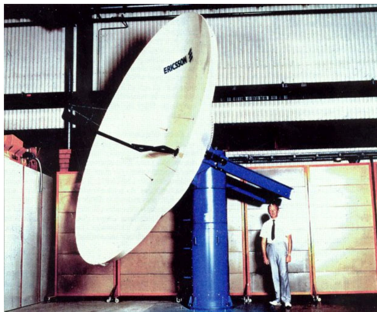
Med övergång till längre våglängder följer krav på större radarantenn. Jämförelse med personen visar den betydande storleken på antennen hos PV 883. Dessa radarantennar monterades i bollformade skyddshöljen.
