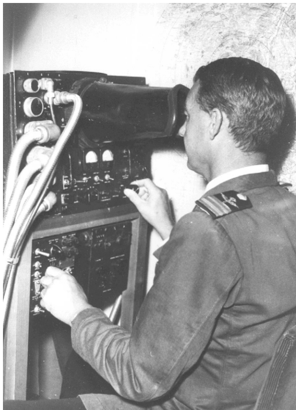
Den första väderradarn PS 29 hade ett mycket ljussvagt PPI som krävde avskärmning med s k stövel. Endast kraftigare nederbörd kunde detekteras. Vid PPI Helge Olin, flottilmeteorolog vid F 9 på Säve. (Bilden tagen c:a 1960).
