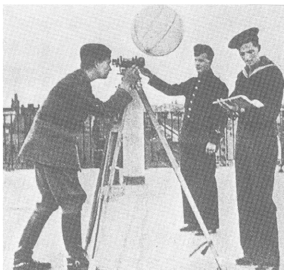
Värnpliktiga kommenderades till tjänstgöring vid MV från alla tre försvarsgrenarna. Här ses en höjd- vindmätning med pilotballong utföras från SMHA:s tak Fridhemsgatan 7. (Bilden tagen 1940).
