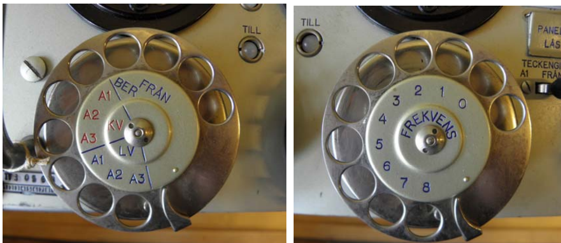
Fingerskivan för val av vågtyp och sändare. Val av förinställd frekvens.
