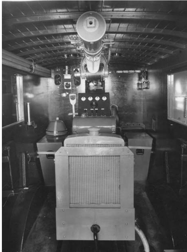
Generatoren med bensinmotori Maskinbilen, Foto Flygvapenmuseum
