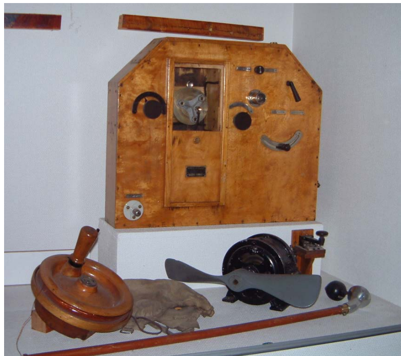
Flygradio Fr m/17 eller Fr m/ä med luftpropeller. Foto A.Larsson
