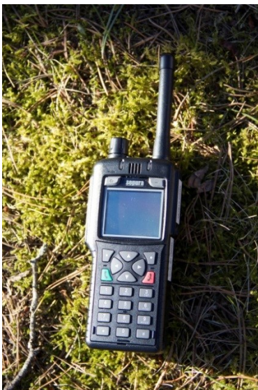
Bild 20 Liten antenn. Radiostation, Radio 1444 (Rakel), ca 400Mhz, UHF-området.
