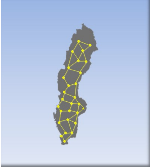
Bild 3 FTN maskformigt stomnät, princip.
