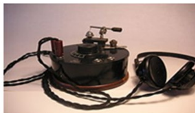
Svensk kristallmottagare av märke Radiola och tillverkat av Svenska Radioaktiebolaget 1925. Instrumentet överst på mottagaren är detektorn med sin tunna metalltråd mot kristallen
