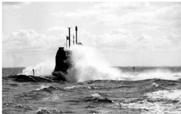
Sjöormen – kortvågsantennen har den horisontella plattan (Bengt Rasin)
