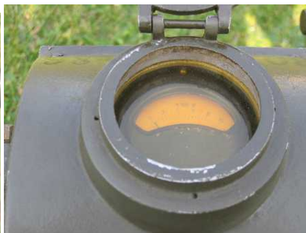
Voltmeter för mätning av generatorns polspänning
