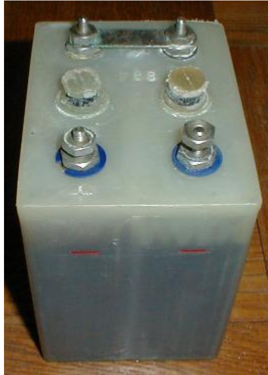
Nifeackumulator typ D22, 2,4 V 22Ah. M2673-103000, äldre beteckning Td 34010 Vikt: 2,0 kg
