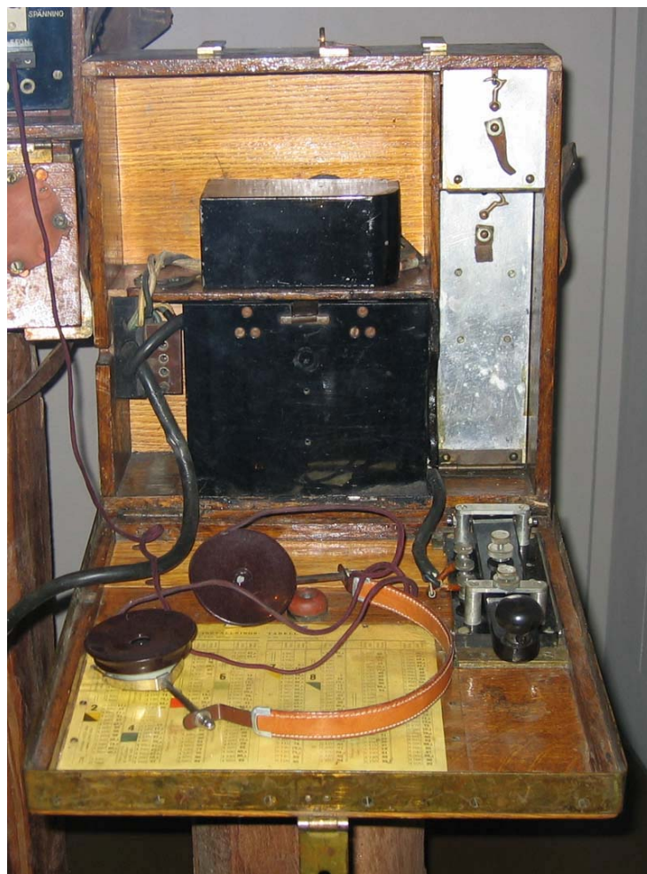
1 W Br m/28, materiellåda med telegrafnyckel och hörtelefon Foto taget på Armémuseum, Stockholm februari 2007
