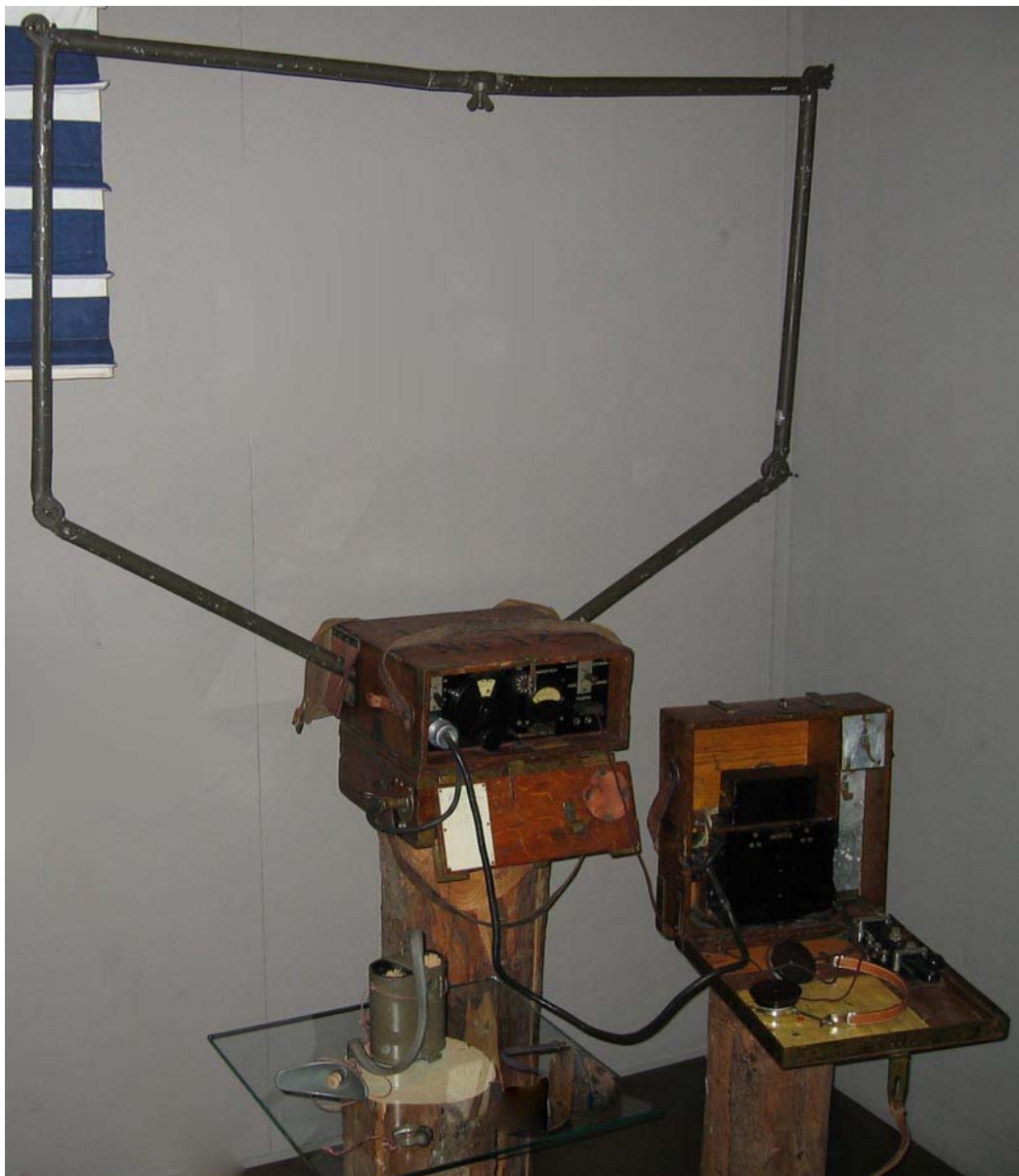
1 W Br m/28, apparatlåda med ramantenn och materielåda Foto taget på Armémuseum, Stockholm februari 2007
